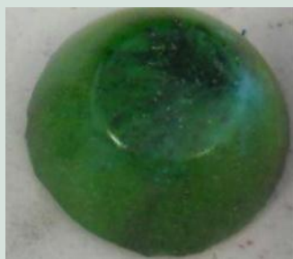
Primeri prvih laboratorijskih testov taljenja barvnega stekla z eko materiali
