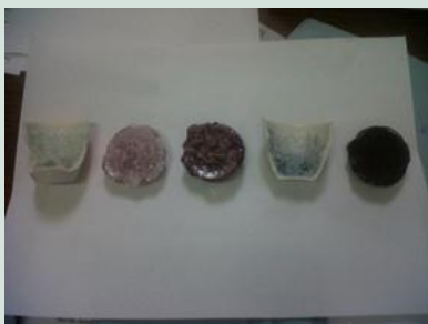
Primeri prvih laboratorijskih testov taljenja barvnega stekla z eko materiali
